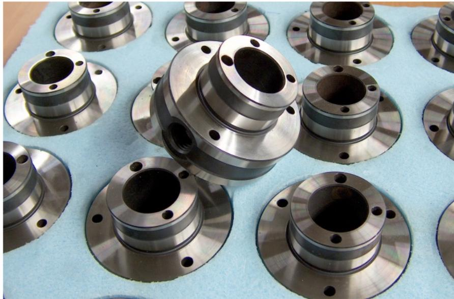
**Komplett bearbeitet:** Vom Vordrehen, Bohren und Fräsen über das Fertigdrehen, Härten und Präzisionsschleifen beherrscht der Spindelhersteller jetzt die gesamte Logistik- und Produktionskette im eigenen Haus
