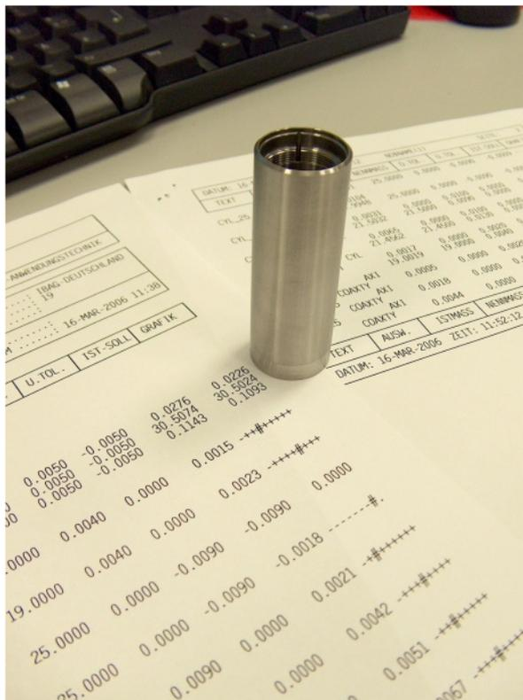
**Nachweis für höchste Genauigkeit:** Automatisch von den Koordinaten- und Rundheits-Messmaschinen erstellte Protokolle dokumentieren, dass Fertigungsgenauigkeiten von wenigen µm eingehalten wurden
