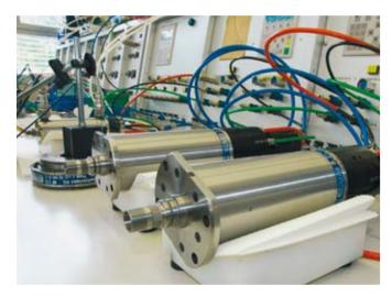
Im Labor durchlaufen alle Motorspindeln ein Prüfprogramm mit Probelauf. Die Losgrößen reichen von 1 oder 2 Stück bis zu mehreren hundert. Geliefert wird in alle Teile der Welt.
